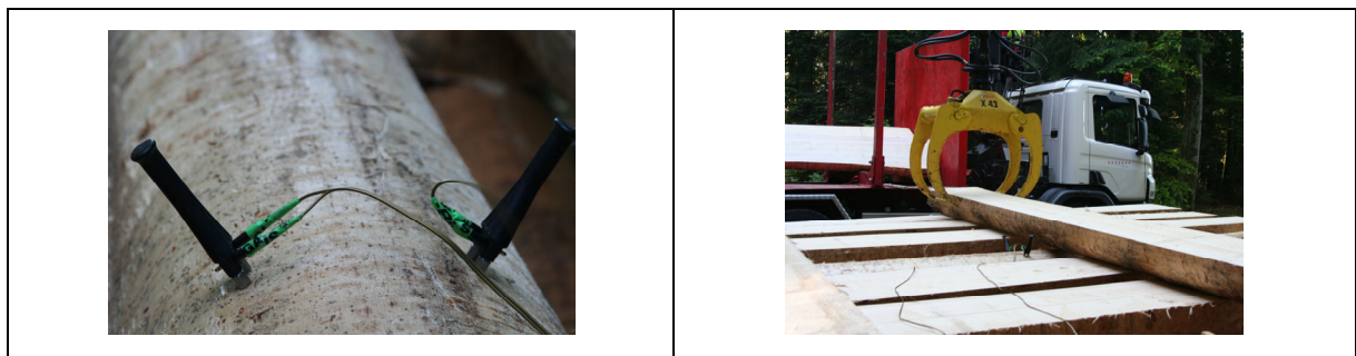
Figure 5 et 6- Sondes posées au centre des piles
