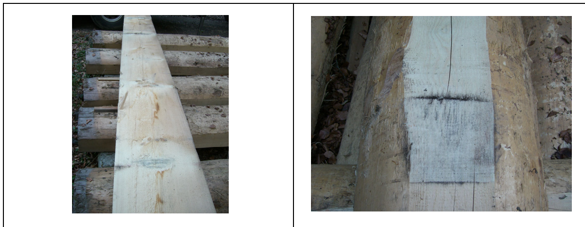
Figure 7 et 8 – Bleuissement superficiel apparu aux endroits de contacts entre les billes de bois
