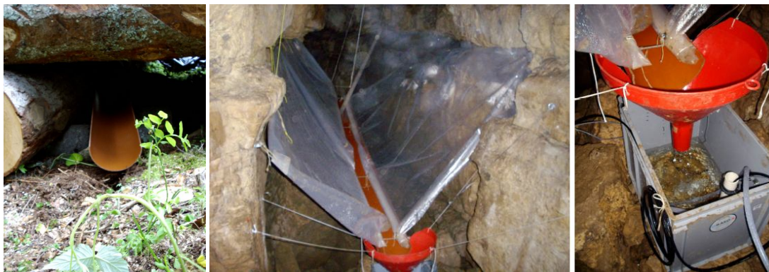
Fig. 2.4 Illustrations du dispositif d'échantillonnage et de mesure sur le site du Grand Bochat. A gauche : rigole récoltant l'eau ruisselant sous la pile de grumes (entrée du système sol) ; au centre : bâche récoltant l'eau à l'exutoire dans la grotte ; à droite : mesure en continu du débit au moyen d'une sonde de pression et d'un déversoir préalablement calibré.
